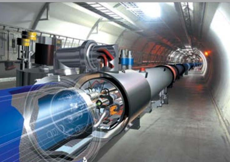
Slika 2: Skica dipolnih magnetov v tunelu LHC, ki ukrivljajo smer protonskim curkom. Ker bodo v trkalniku LHC trkali protoni s protoni sta v magnetu dve vakuumski cevi z nasprotno usmerjenima curkoma (na sliki viden le eden, označen z zeleno). Celotna struktura je vstavljena v velik kriostat, ki vzdržuje nizko temperaturo za superprevodno delovanje magnetov. (Vir: CERN)
